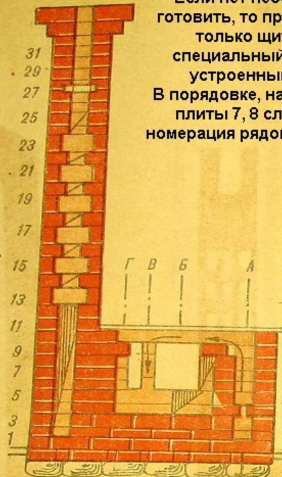
Печь-плита конструкции И.Б.Белина и Т.И.Лаппа-Старженецкого. Теплоотдача 2500 ккал/час.
