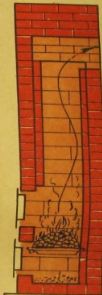
Топливник для печи теплоотдачей 3200 к.ч.
